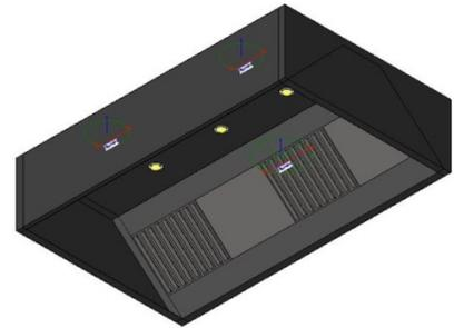
La géométrie de la hotte a été conçue pour minimiser la façade inférieure arrière et le plenum de compensation afin d'offrir une zone de captation maximale et donc une efficacité optimale.
