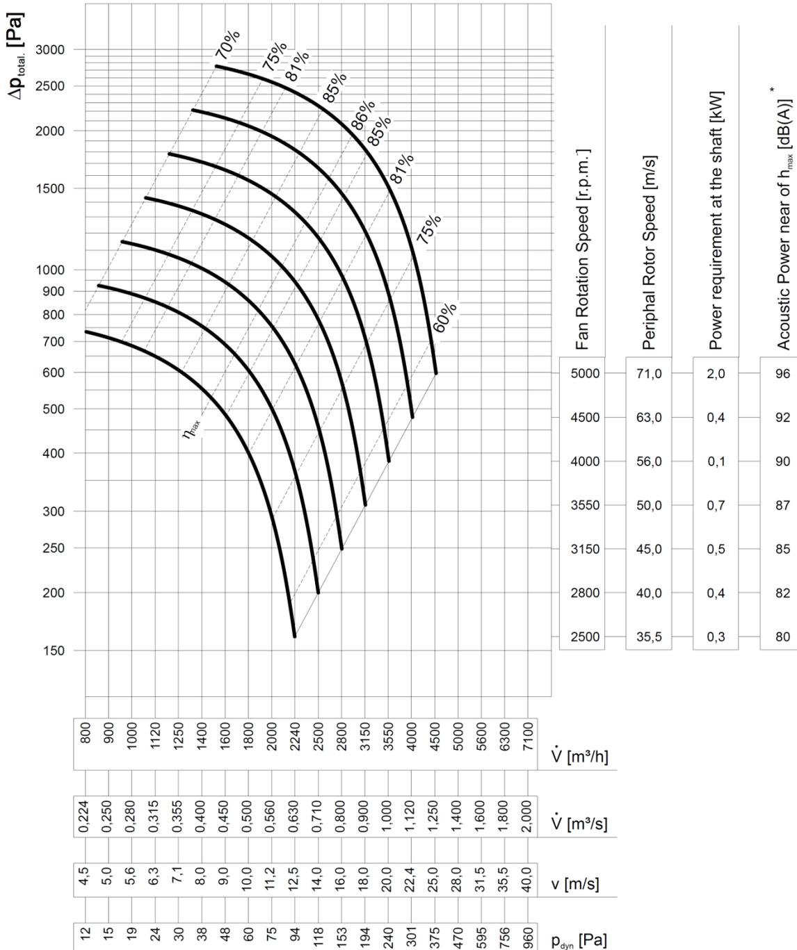
\*Pression acoustique à 3 m de distance conforme à la puissance acoustique réduite de 16 à 18 dB (A)
