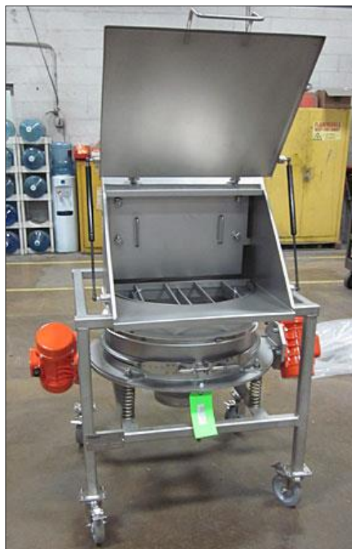
Installation d'un tamis sous poste vide-sac
