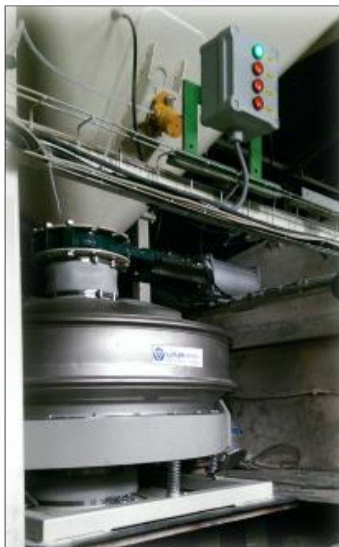
Installation d'un tamis sous une trémie
