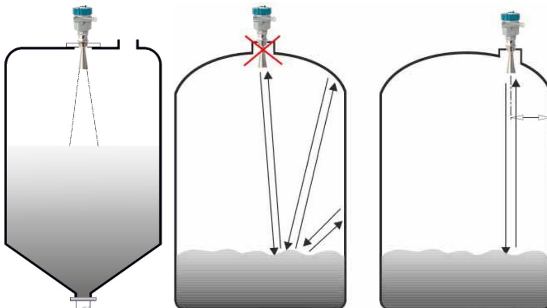
Si possible, essayez d'éviter les versions verticales ou au moins de réduire ses dimensions. L'extrémité du transducteur doit dépasser d'au moins 10 mm du tube de support. Nous recommandons la version RPL56 en présence de longs tubes verticaux montés sur de petits tubes ou dans des applications à faible constante diélectrique.
