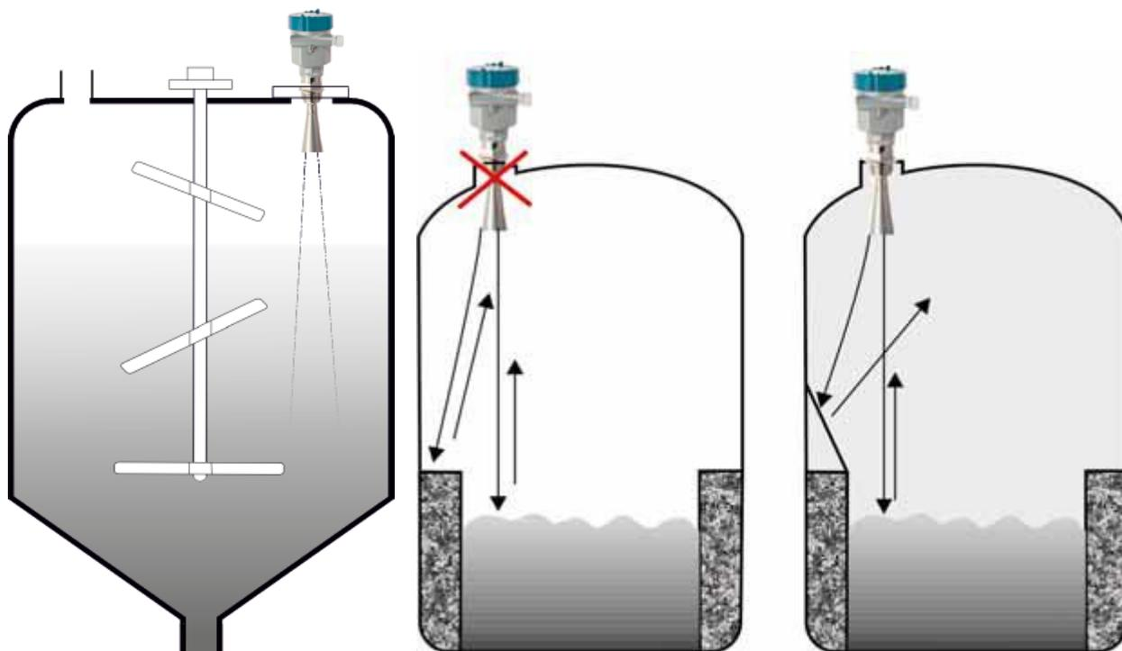
Il est conseillé d'opter pour une installation avec tuyau vertical (ou tube de dérivation) afin d'éviter l'influence sur la mesure causée par des barrières à l'intérieur des réservoirs ou la génération de mousse.
