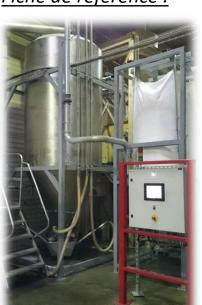
Mécanisation et automatisation de l'alimentation en matière première de 3 lignes de roto-moulage
